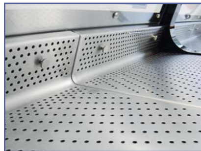
Effiziente Tischabsaugung verhindert das Aufsteigen der Lösungsmitteldämpfe
