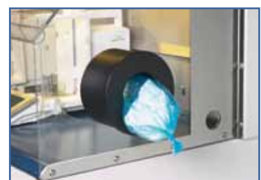
Abfallentsorgungs-System und Kabeldurchführung
