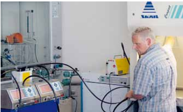
HEPA-Filterleckage-Test an einer Sicherheits-Werkbank.
