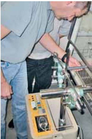
Bereitstellung der Prüfeinrichtung für den Ausbruchstest («KI-Discus-Test»).
