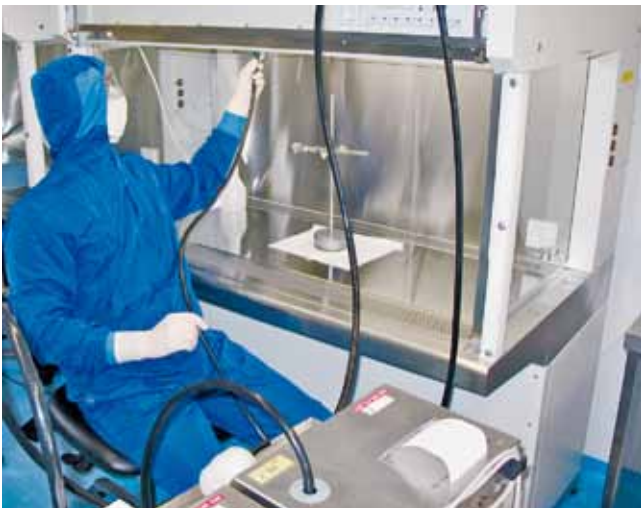
HEPA-Filterleckage-Test an einer Sicherheits-Werkbank.
