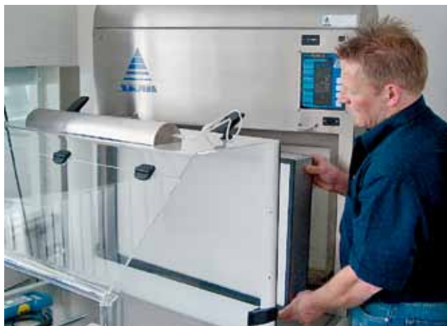
Häufiger Einsatz: Wechsel des HEPA-Vorfilters der SKANAIR® HFC.
