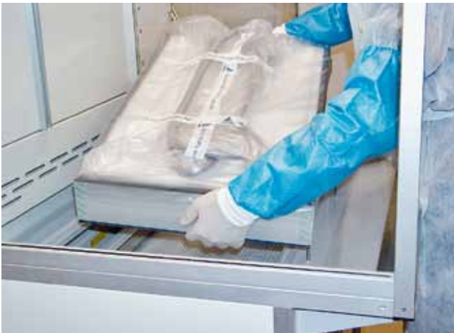
Ausbau einer kontaminierten HEPA-Filterkassette aus der Skanair® Workstation im Bag-Out durch den Arbeitsraum hindurch.
