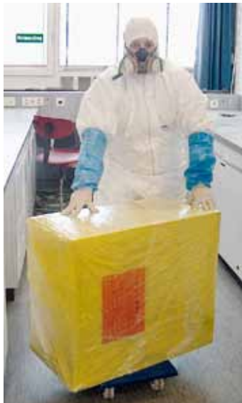
Eine verpackte kontaminierte Kleinanlage, fertig für den Abtransport zur Entsorgung.
