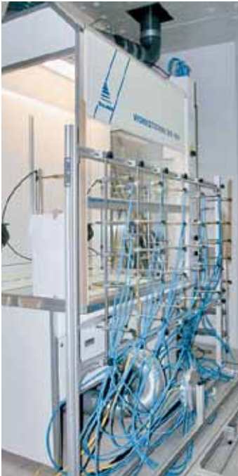
Ausbruchstest (hier nach SN EN 14175) an einer SKANAIR® Workstation.
