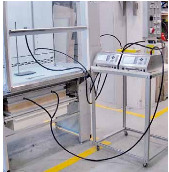
Aufbau für die Messung der HEPA-Filterintegrität an SKANAIR® Workstation AS.
