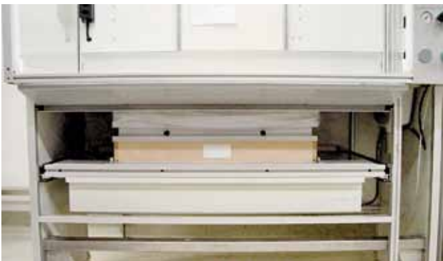
Geöffneter Unterbau eines Laborabzuges Skanair® Workstation mit Umluft-Filterkassetten (HEPA-Filter und Aktivkohle).
