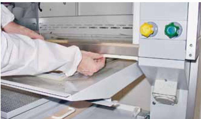
Dichtungswechsel am geöffneten Unterbau der Skanair® Workstation.
