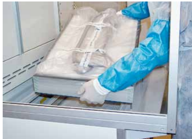
Démontage, avec le système sécurisé Bag-out, d'une cassette filtrante HEPA contaminée à travers la zone de travail d'une Skanair® Workstation.
