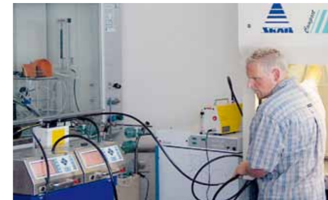
Test de fuite des filtres HEPA dans un poste de sécurité.
