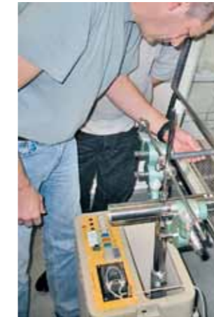
Mise en place du matériel d'essai pour le test de confinement (test «KI-Discus»).
