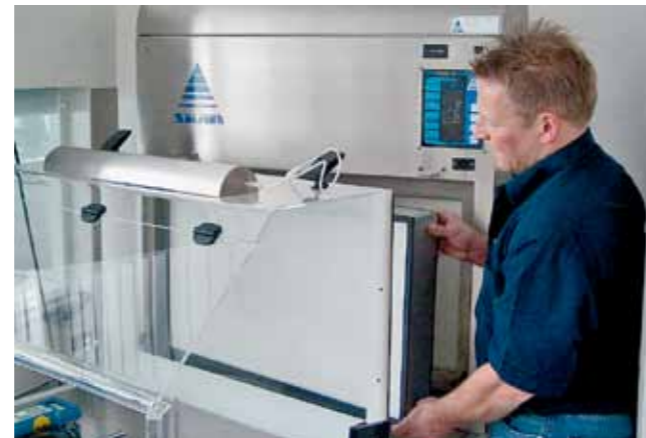
Une intervention fréquente: le remplacement du préfiltre HEPA du SKANAIR® HFC.
