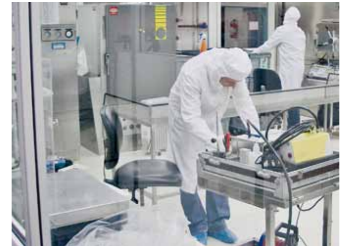
Mesure standard de paramètres d'une salle blanche.
