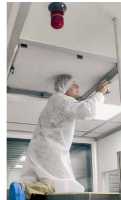
Le technicien prépare un filtre plafonnier pour la mesure.
