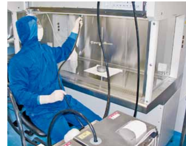
Test de fuite des filtres HEPA dans un poste de sécurité.
