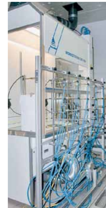
Test de confinement (ici selon SN EN 14175) d'une SKANAIR® Workstation.
