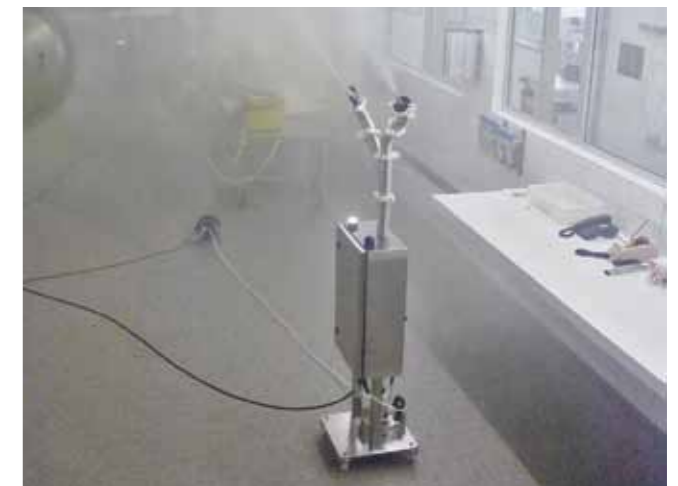
L'unité de vaporisation Skanair® SolidFog pour le peroxyde d'hydrogène dans une production.
