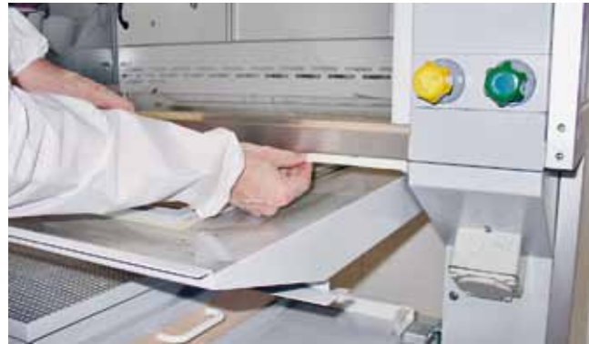
Remplacement des joints à la substructure ouverte d'une Skanair® Workstation.
