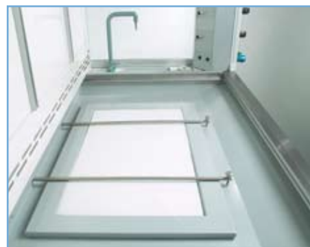
Bac collecteur sous la table avec un système de filtrage HEPA / charbon actif
