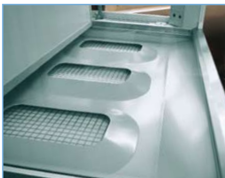
Bac collecteur sous la table avec des cassettes de filtres à charbon actif
