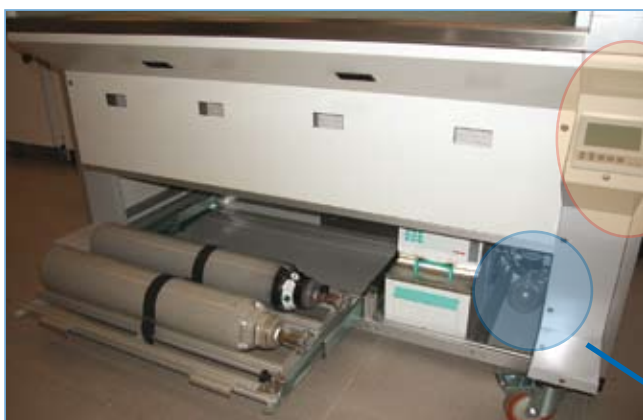
Réalisation d'une zone de rangement pour bouteilles de gaz, une pompe à vide et un cryostat
