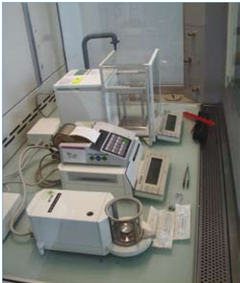
La Workstation WS-AS en tant que zone de pesée protégée avec des balances au microgramme et au demi microgramme
