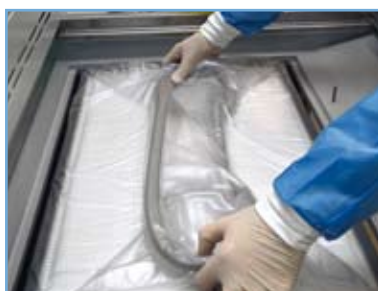
Changement de filtre avec faible risque de contamination grâce au set AS (type 3)
